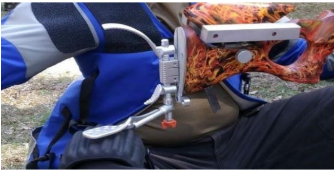
Figura 2 – Parte posteriore di calcio od uncino modificati per fornire un appoggio supplementare al corpo.
